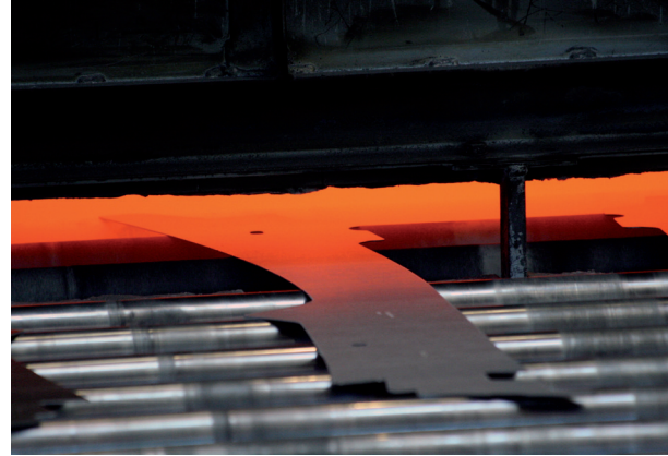
Proyecto COOPHS: proceso de producción de aceros de estampación en caliente
