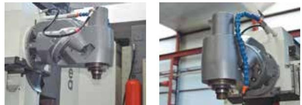
Así mismo, se revisaron, o sustituyeron en caso necesario, todos los elementos como juntas, rodamientos, engranajes, bomba y central hidráulica, cajas de velocidades, acumuladores, etc., y, en general, cualquier componente funcional de la fresadora necesario para garantizar la fiabilidad y funcionalidad de la misma.
