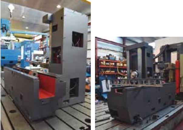
**a) Rodamientos y husillos en los 3 ejes (X, Y, Z):** Se sustituyeron todos los rodamientos y se precargaron todos los husillos de cada eje. Así mismo, se revisaron o sustituyeron todos los elementos de transmisión de los accionamientos como correas, poleas, etc.
