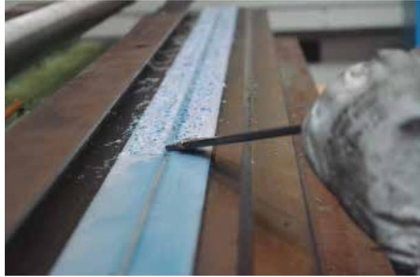
**c) Armazón:** Se rectificaron las guías de fricción inferior, así como las guías de fricción laterales de turcrite o biplast. Posteriormente se llevó a cabo el ajuste con el carnero ya rectificado mediante rasqueteado manual.
