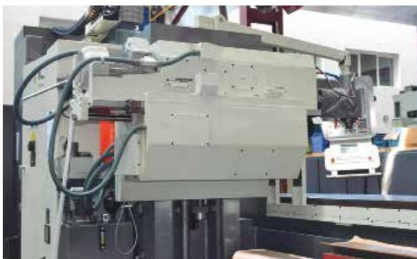
En las pletinas de apriete, se retiraron los viejos elementos de turcite o biplast, sustituyéndose por unos nuevos, rectificándose posteriormente y ajustándose mediante rasquetado manual con las guías del carnero superiores.
