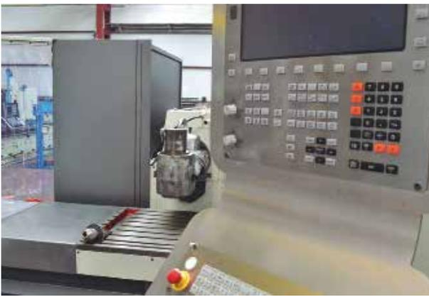
Como principal consecuencia de esta reconversión con un nuevo control numérico, destacó la necesidad de realizar una nueva instalación en el cuadro eléctrico para adaptar el control viejo inicial a este nuevo control TNC-320, necesiéndose nuevas entradas, salidas y cableado externo.
