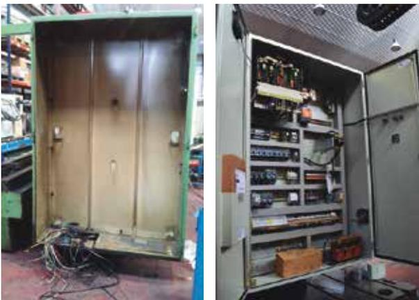
Se realizó también la instalación de un nuevo motor del mandrino, debido a la necesidad de convertir la corriente trifásica de entrada de 220 V a una corriente de 400 V. El resto de motores fueron desmontados para su total revisión. También se inspeccionaron y limpiaron los drivers de los ejes.
