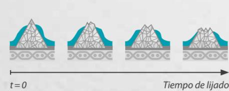
El grano abrasivo cerámico con forma geométrica se desgasta de una manera predeterminada, produciendo continuamente nuevas aristas afiladas
