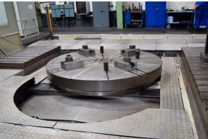
Plato de torneado y fresado / Turning and Milling Chuck: BOST Ø 2500mm (2008)
