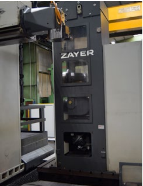
Cambio Automático de Cabezales / Automatic Head Change PICK UP AITEK ACH station 4 POS
